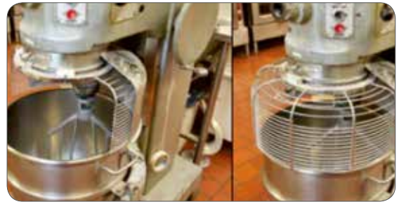
Şekil 16: Koruyucu donanım kapanmadan çalışmayan bir makine
