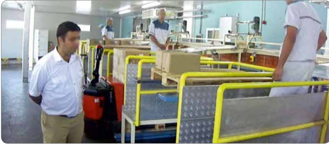
Şekil 4: İyi uygulama örneği: Çalışanların eğilerek yük kaldırmasının ve taşımalarının engellenmesi için yapılmış hidrolik sistemi ve konveyörler
