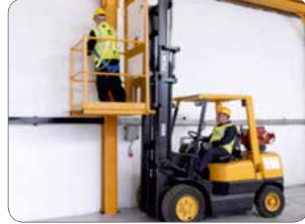
Şekil 10: Çalışanların forklift ile güvenli kaldırılması
