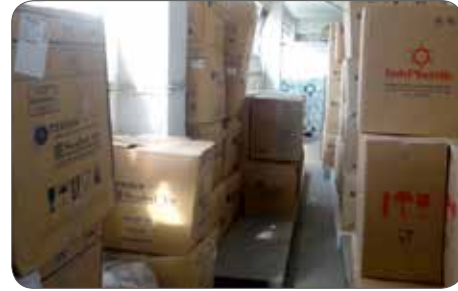
Şekil 7: Geçiş alanı dar, yangın önlemi alınmamış depo
